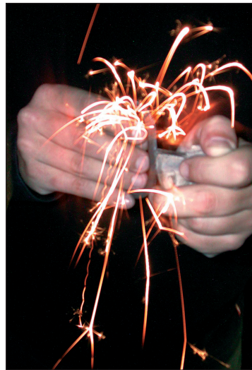
■ Fig. 13 L'étincelle produite par la percussion d'un silex sur le briquet est un petit copeau d'acier qui brûle grâce à l'oxygène de l'air (cliché: B. Roussel).
