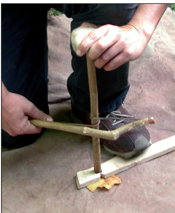
■ Fig. 5 Utilisation du foret à archet. L'archet permet de faire tourner très rapidement le foret, cette technique est très rapide et efficace (cliché: B. Roussel).
