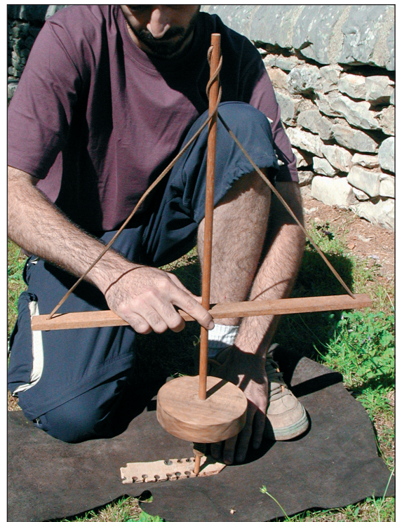
■ Fig. 7 Utilisation du foret à pompe ou foret à volant d'inertie (cliché: B. Roussel).
